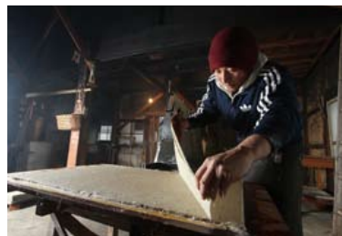
水分を切った紙は一枚ずつ乾燥させる。川原さんは手漉きで日本一薄い紙を漉く。現在も機械に負けない薄さを目指して研究中。
