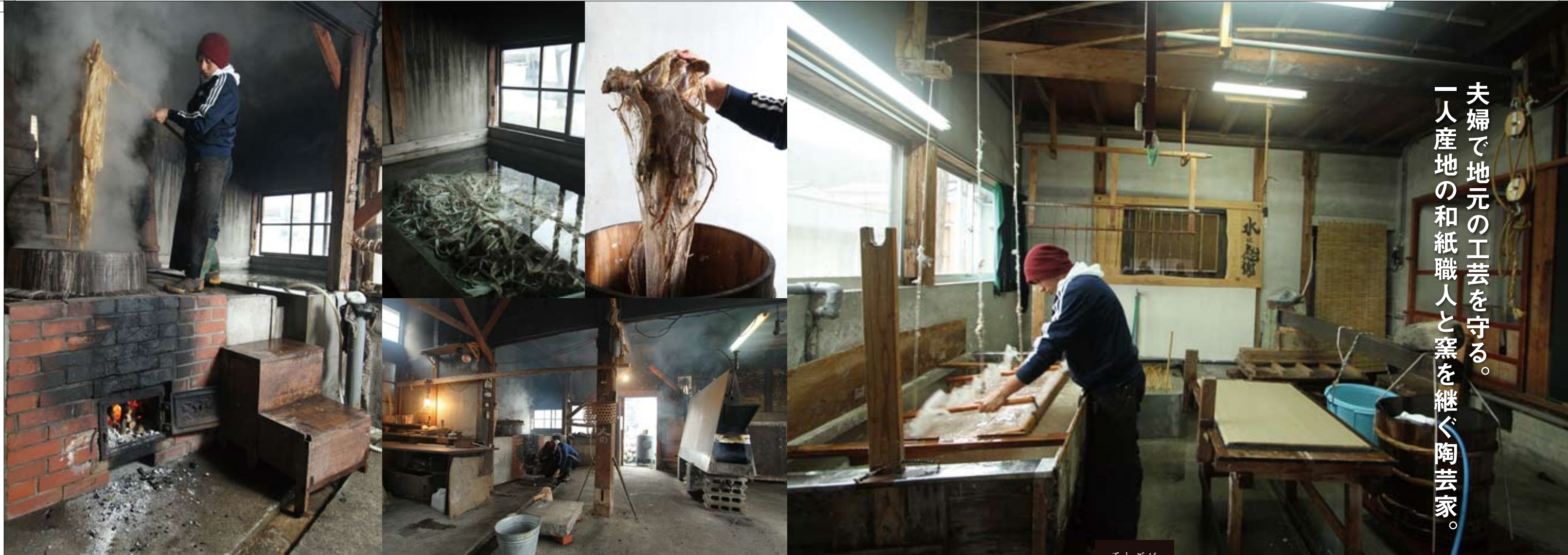
薪をくべて火を起こし、大きな釜で楮を煮る。水にさらした後、木桶で叩いて繊維をばぐす。通常は一工程を丸一日続ける。
